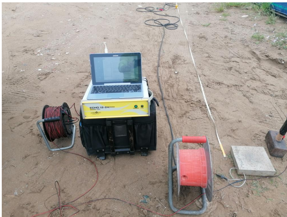
Foto 2: Particolare del sistema di acquisizione a 24 canali (MASW N. 1)
